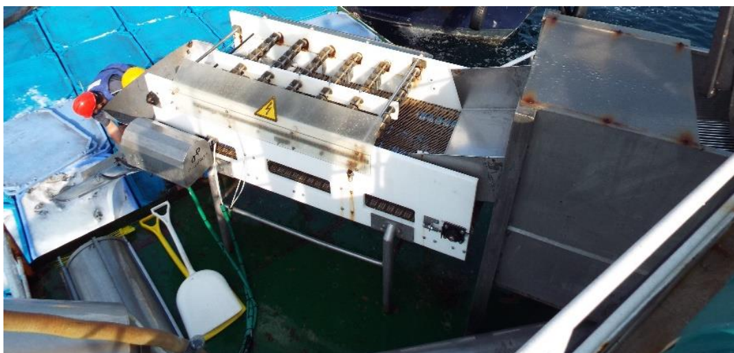
Figure 3. Le dispositif d'étourdissement utilisé par SÛRSAN pour les bars et les daurades Sur la droite de la photo, l'unité d'assèchement.
